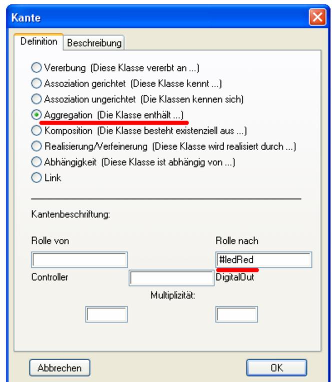
Die Klasseninstanz muss jetzt noch initialisiert werden. Dies erfolgt in der *powerOn*-Methode. In diesem Beispiel soll die rote LED mit Port D, Bit 0 verbunden sein.
